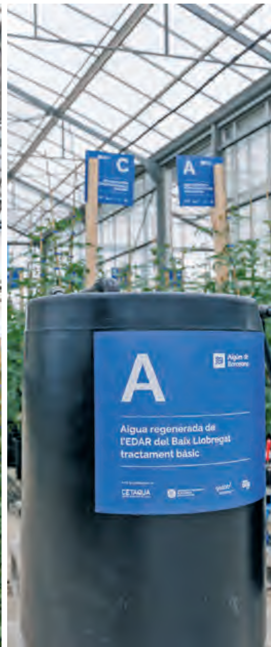
AL PARC AGRARI DEL BAIX LLOBREGAT S'HA IMPLANTAT UNA ESTACIÓ PILOT EN UN HIVERNACLE DE L'AGRÒPOLIS DE LA UPC AMB DIFERENTS CULTIUS EXPERIMENTALS REGATS AMB FINS A SIS TIPUS D'AIGÜES DE DIFERENTS ORÍGENS DEL BAIX LLOBREGAT, ENTRE ELLES, LA REGENERADA
