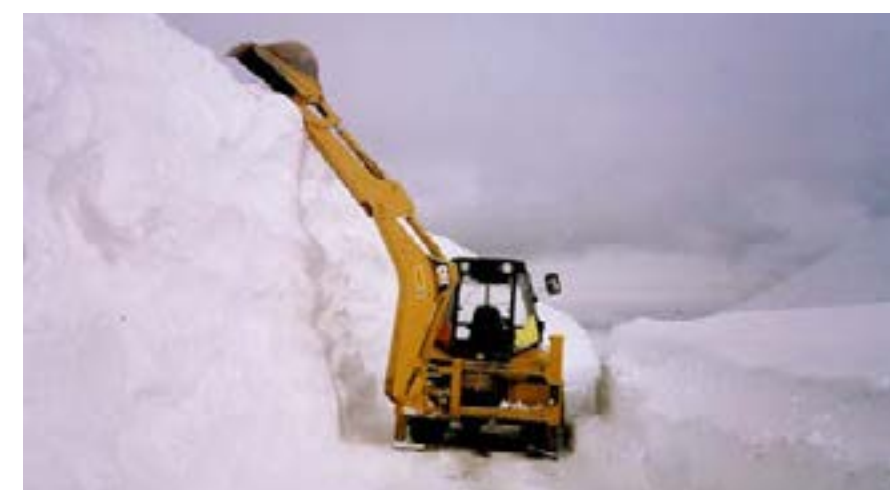
QUAN NEVA, PRIMER ES RETIRA LA CAPA MÉS GRUIXUDA DE NEU I DESPRÉS S'ESTÉN LA SAL. LA DIPUTACIÓ DISPOSA DE DIFERENTS TIPUS DE MAQUINÀRIA PER TREURE LA NEU, COM ARA FRESSADORES, CAMIONS LLEVANEUS I ALTRES TIPUS DE MAQUINÀRIA. LA XARXA DE CARRETERES LOCALS DE LA DIPUTACIÓ COMPTA AMB MÉS DE 1.500 KILÒMETRES PERÒ LES VIES QUE ESTAN AL BERGUEDÀ, BERGA I OSONA SÓN ON MÉS NEVA | DIPUTACIÓ DE BARCELONA
